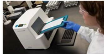
Selle en **Quanti-Tray Sealer** y coloque en la incubadora a  $35\text{ }^{\circ}\text{C} \pm 0,5^{\circ}\text{C}$  durante 24 horas (en otros países, el requisito de temperatura puede ser diferente según los requisitos reglamentarios).
